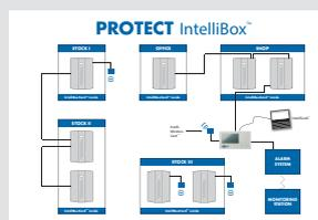
Hier werden drei mögliche Verbindungsmöglichkeiten mittels IntelliBox angezeigt.
