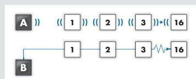
Jede IntelliBox kann bis zu 3 Nebelkanonen steuern. Je nach benötigter Sicherheitsstufe kann man zwischen kabelloser Verbindung (A) oder Bus-Verbindung (B) wählen.
